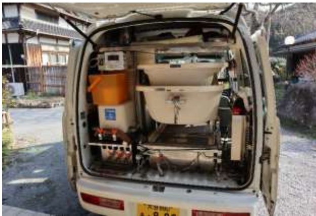
入浴車の後部に積まれた分割された浴槽をおろし、利用者宅に設置します。
