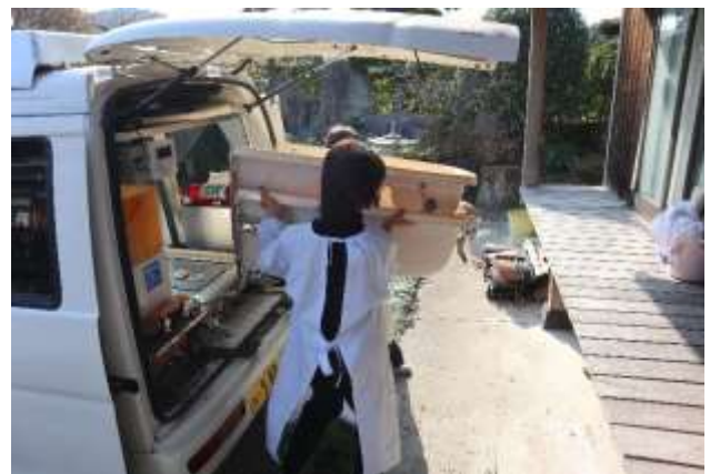
入浴車の後部に積まれた分割された浴槽をおろし、利用者宅に設置します。
